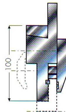
Porte-outil avec serrage hydraulique et compensation avec cales de réglage. longueur standard 150 mm.
